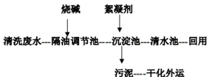
图 3-2 项目生产废水处理工艺图
